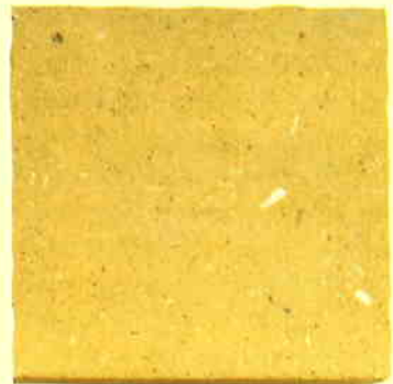
硬化遅延剤による仕上げ
